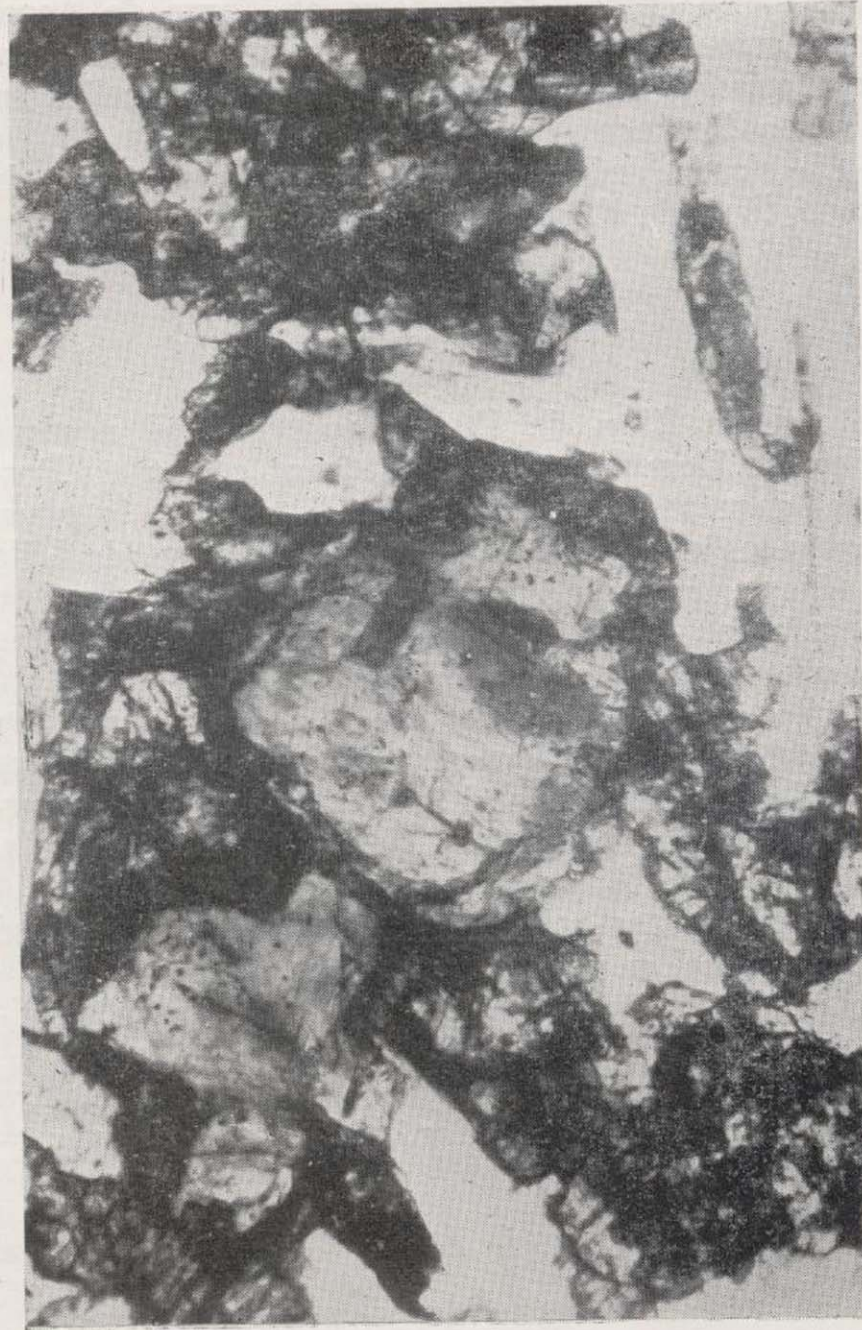
Fig. 3.—Dolérite pigeonnitique (Éch. 41). Pyroxène, feldspath, minéral et au centre, un gros cristal de l'olivine. Lumière naturelle. \times 10 .
